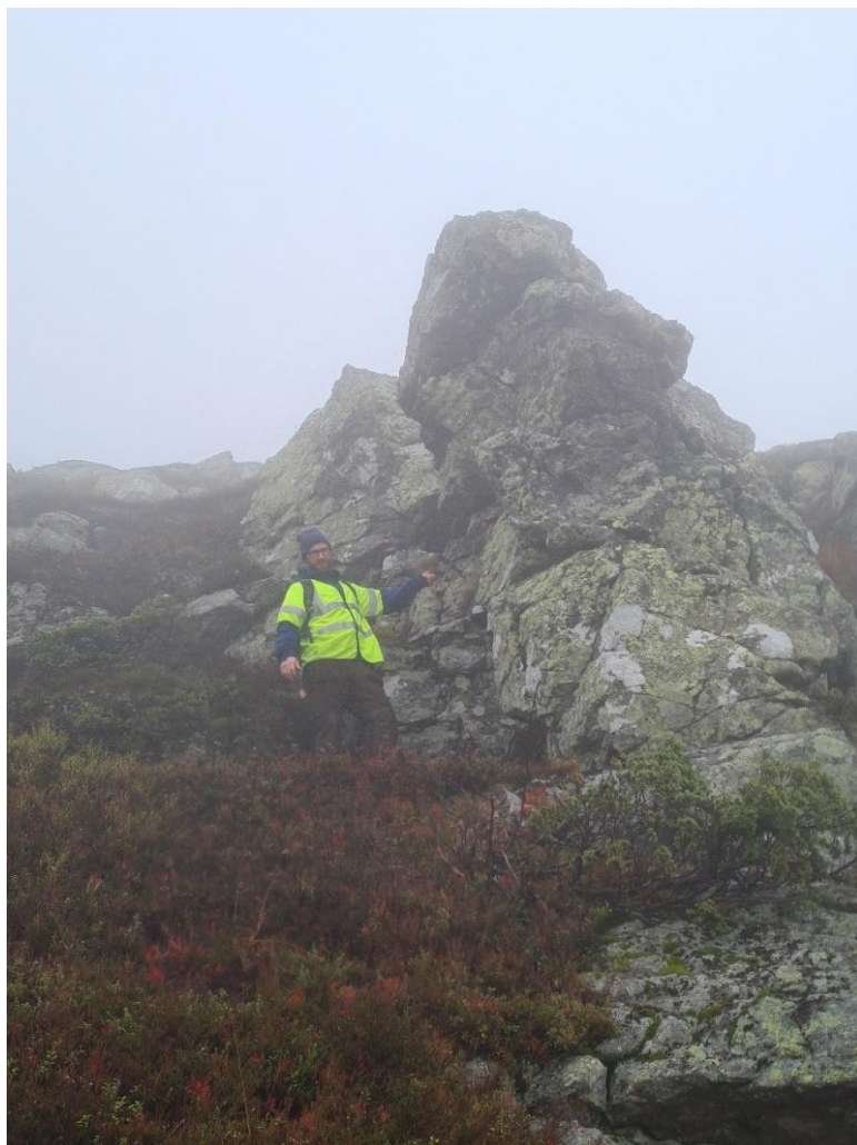
Figur 4-2: Avløste blokker i berghammer ved Julbokskjøre med potensiale for steinsprang.
