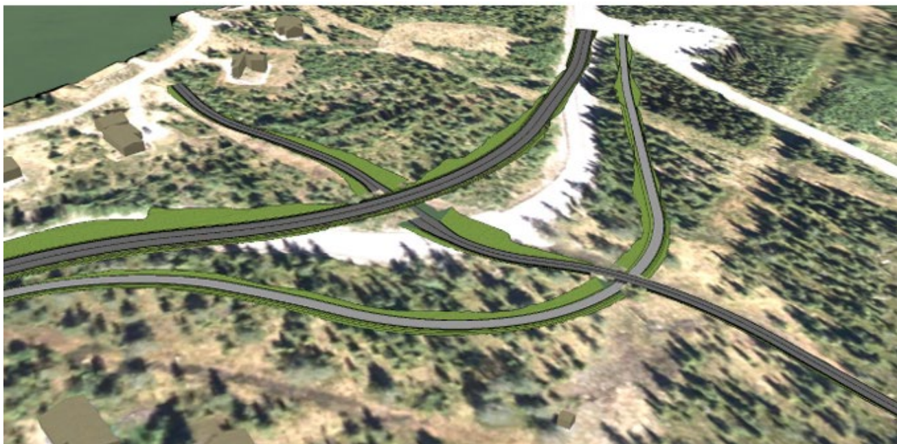
3D-illustrasjon av planfri kryssing mellom Fageråsvegen og skiløypene (illustrasjon Norconsult, fra planid: 20160300).
