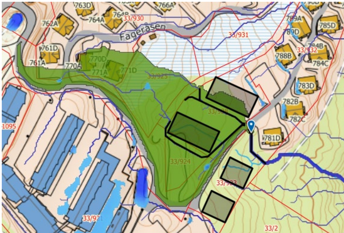
Figur 10 - Nedbørsfelt for flomvei gjennom vei, kilde Scalgo.com
